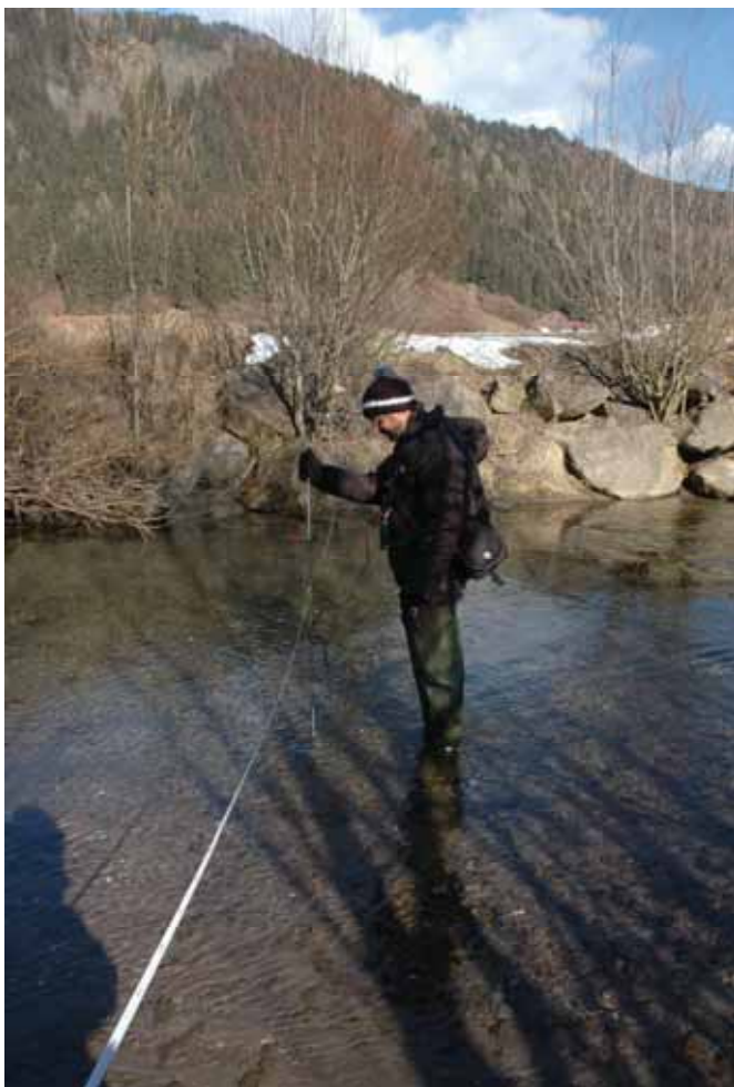
*Durchflussmessung mit dem Hydrometrischen Flügel
