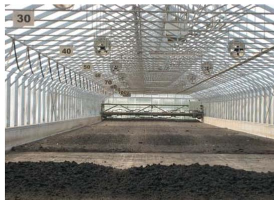
Abbildung 72: Solare Klärschlamm-trocknungsanlage des Abwasserverbandes Leibnitzerfeld Süd
